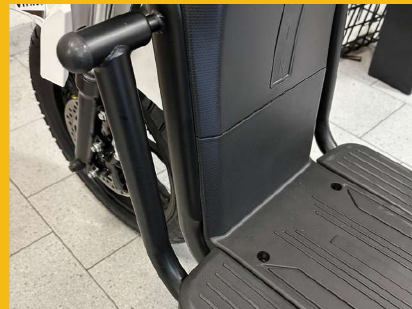
Protecciones laterales en caso de caída
