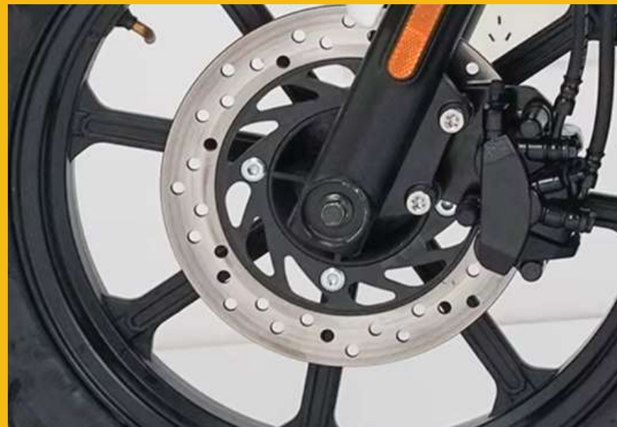
Freno de disco delantero con control de estabilidad CBS
